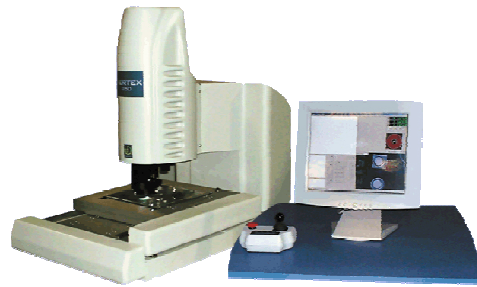
圖 6. Micro-Vu 非接觸式光學設備，以此設備量測翹曲量值。
