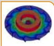
模擬塑料被導入預先加熱的模穴而軟化及固化的壓縮成型製程，協助使用者預測因高熱與高壓所導致的潛在成型問題，進而決定最適塑膠材料及優化加工條件。同時，使用者能自訂初始進料、受壓區域及條件等，最佳化產品品質，避免翹曲產生。
