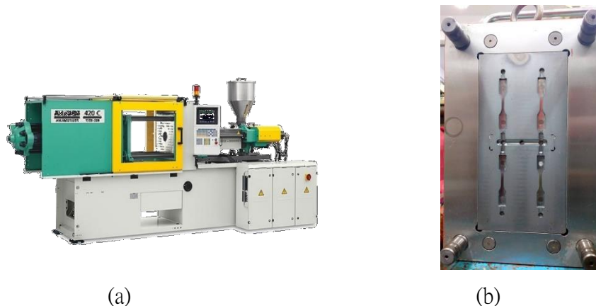
圖2. (a) 實際實驗射出機台Arburg 420C 1000-350-40，(b) 實際模具結構
